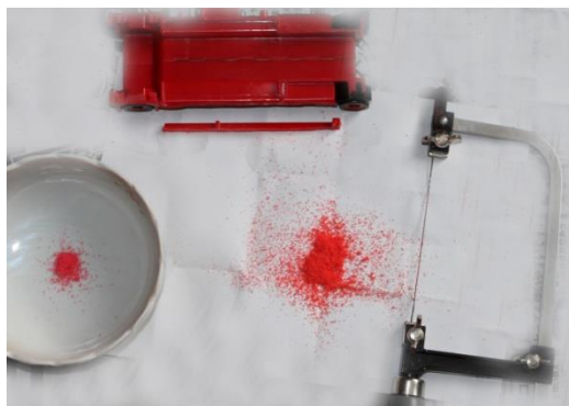
図-2 赤い塩ビ材を鋸で挽いた粉
