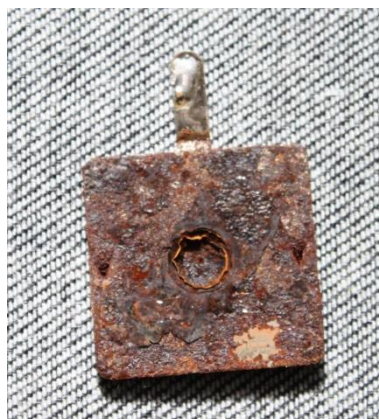
図-6 正極の極板の錆
