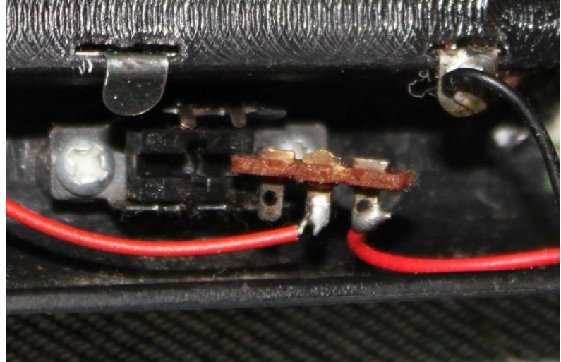
図-2 内部で外れていたスライドSW
