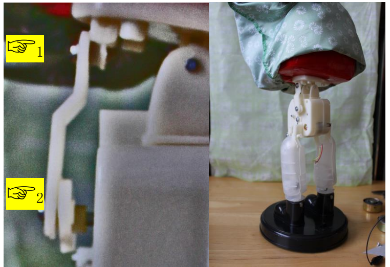
図-7 頭部を左右に傾ける仕組み
