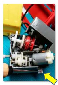
② クレーン BOX の外側 2 個のギア(縦用)の内 1 個割れ有り
