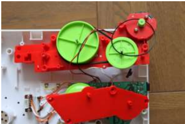
図-3 伸びたモータープーリーから第二プーリーへのベルト
