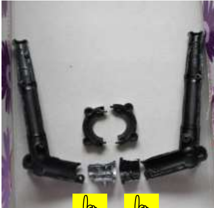
図-5 消火ノズルの折れた状態
