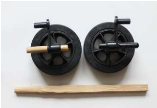
図-1 左 修理後の軸 右 正常な右側縦軸
