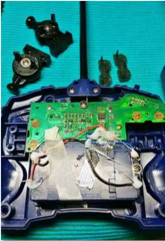
③本体前輪駆動部を分解組立再調整
