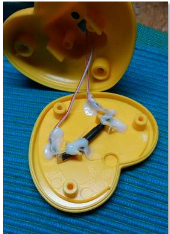
④レヂゴム SW(液晶パネル) 汚れ、特に on/of 《エタノールで清掃点検》
