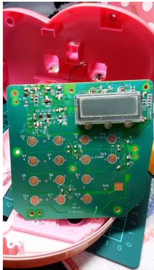
④レヂゴム SW(液晶パネル) 汚れ、特に on/of 《エタノールで清掃点検》
