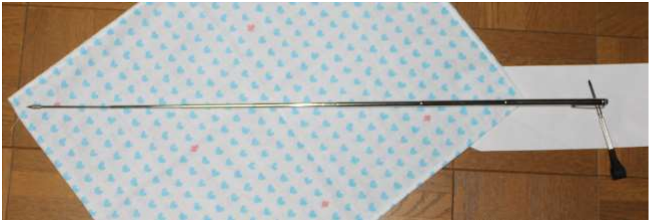
図-6 アンテナに使用した7段伸縮の指示棒
