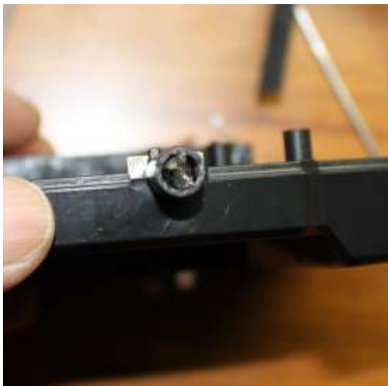
図-3 折れたアンテナ残り
