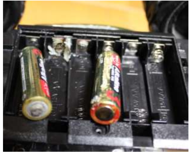
図-2 電池液漏れ・極板錆
