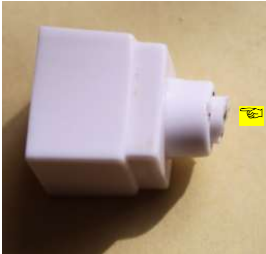
図-6 黄色い矢印は折れて残った部品
