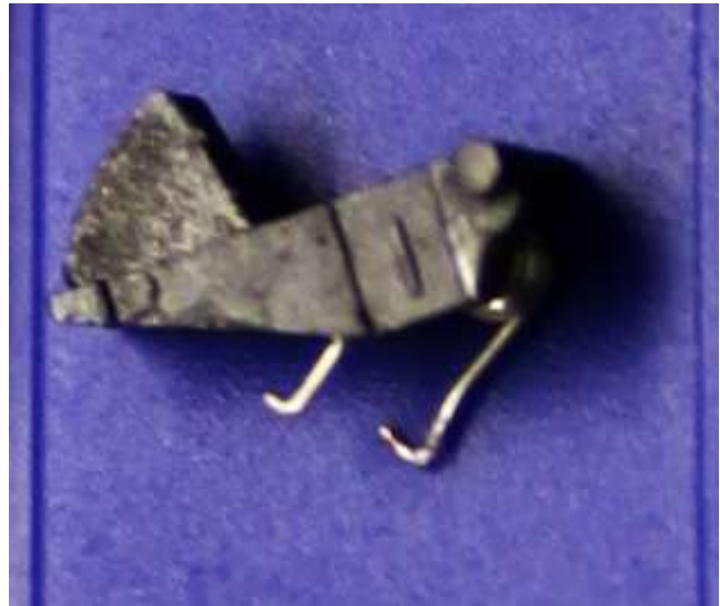
図-6 手入れ前のスイッチ・下の二本足が接片
