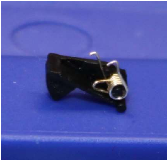
図-5 スイッチの内部の可動接片
