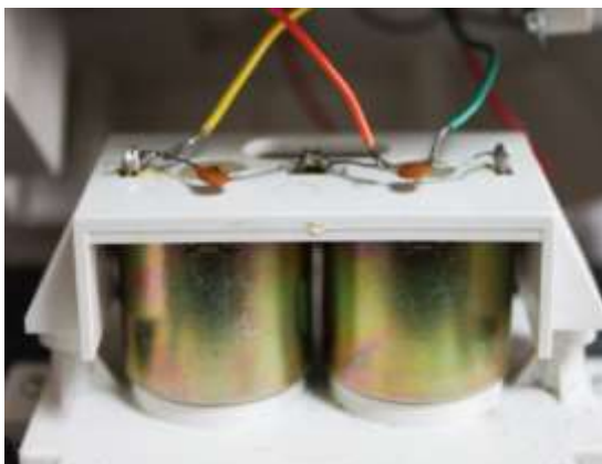
図-1 前後・回転の駆動モーター
