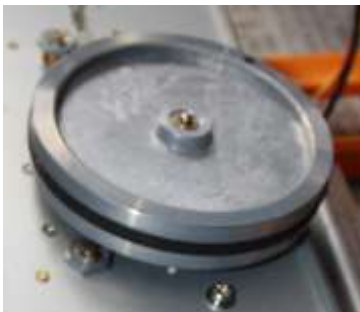
図-4 乾び付いて外れない
