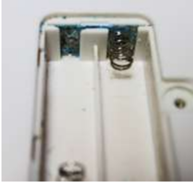
図-1 直列接触側の錆び
