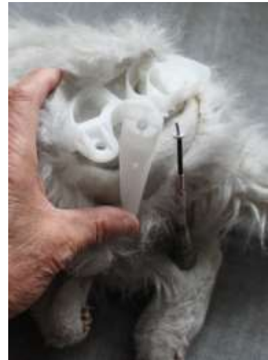
図-3 左後足関節ネジ落下していた
