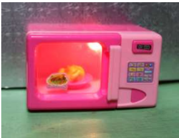
図-1 ランプは点灯するが食品台回転しない
