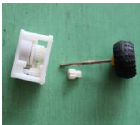
図-5 ギア部と車軸と割れたギア
