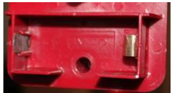
図-5 電池 BOX 手入れ後の状態
