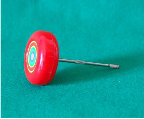
※ 取り外した車輪と車軸 ローレット加工で、取り外しに力を要した
