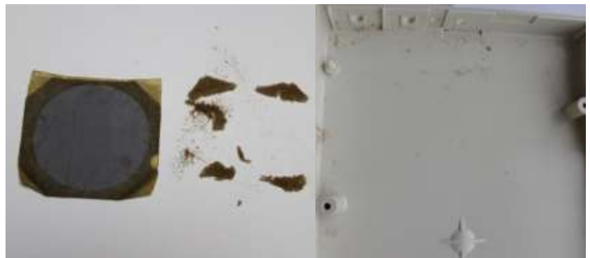
図-6 スポンジが触るだけで崩れる・粉になり散乱
