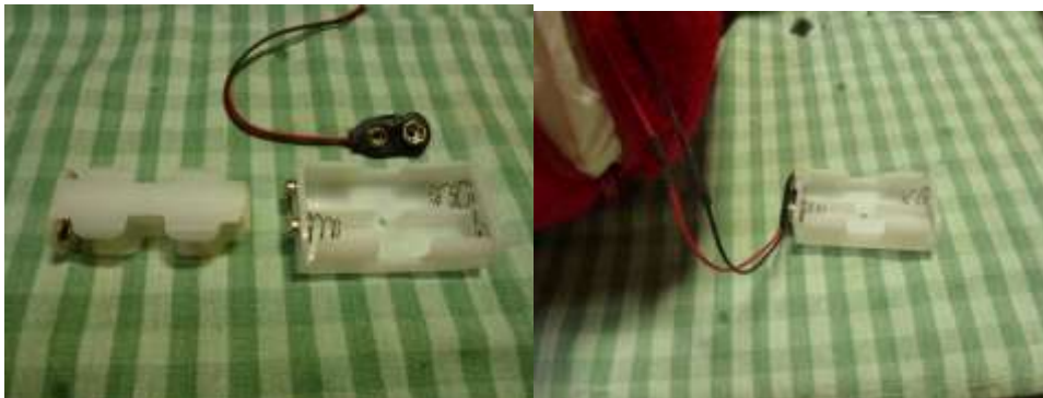
写真② 左、破損した電池ボックス 右、取り替える電池ボックス
