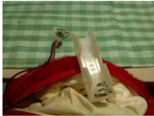
写真① 本体全体写真撮り忘れ、電池ボックスが収まっていた腹部から取り出した破損している電池ボックスとリード線
