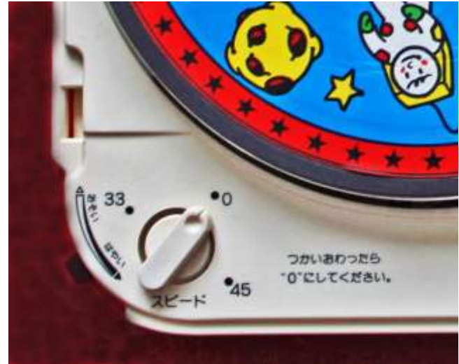
図-2 元の回転切替つまみ拡大図
