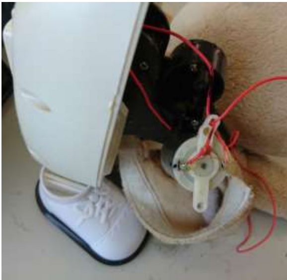
図-5 分解してモーターを取り出す
