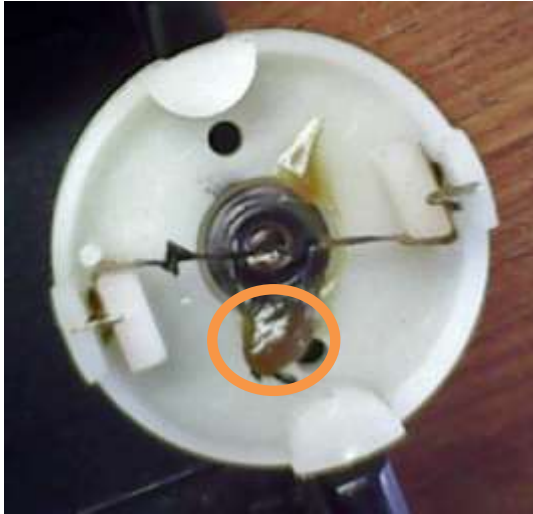
図-8 外した瞬間の図 (円内グリースの塊)
