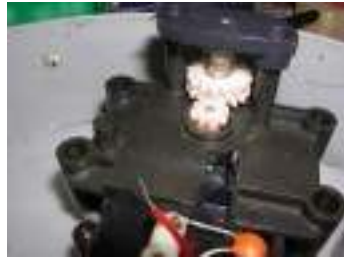
(2) レール駆動ギヤ及び保持ローラー清掃 糸くずとかを巻き込んでいたのを除去する。
