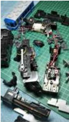
②機関車後輪軸ひし形ギアの割れを接着剤で固定する
